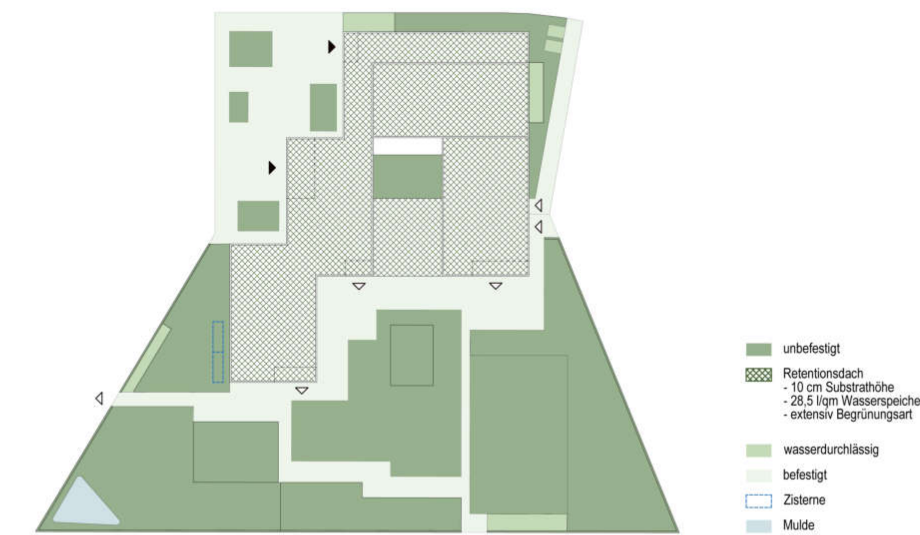
Diagramm Regenrückhaltung und Versickerung und Regenrückhaltung
